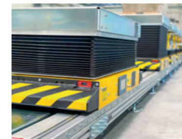
LOGO!MAT eCart: piattaforma idraulica di sollevamento
